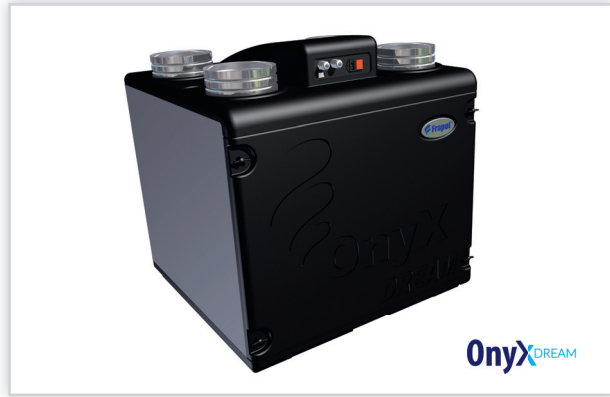
Onyx Dream. Rekuperator dedykowany dla domów jednorodzinnych o powierzchni do 150 m 2 . Kompaktowa budowa i pionowy układ przyłączy ułatwiają zabudowę urządzenia w małych pomieszczeniach. Rekuperatory są fabrycznie przygotowane do montażu w ścianie. Modele: Onyx Dream 400
