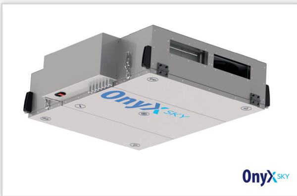
Onyx Sky. Typoszerzeg rekuperatorów podwieszanych, szeroki zakres wydajności umożliwia stosowanie zarówno w wentylacji apartamentów, budynków mieszkalnych oraz małych instalacji przemysłowych, np. w budynkach usługowych lub biurowych. Urządzenia cechuje bardzo mała wysokość, najmniejsza jednostka ma zaledwie 205 mm. Modele: Onyx Sky 200, Onyx Sky 250, Onyx Sky 400, Onyx Sky 800, Onyx Sky 1500, Onyx Sky 3000.
